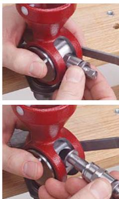
Die Dosierschraube des Pulverfüllgerätes lässt sich auf Knopfdruck, ohne Verlust der Einstellung, austauschen. Diese sind einzeln erhältlich und können beschriftet mit den Matrizen aufbewahrt werden. Dadurch entfällt das erneute, zeitaufwändige Einstellen der Pulvermenge.
