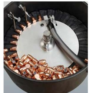
Der Pistol Bullet Feeder arbeitet nicht mit Blei- oder beschichteten Geschossen.
