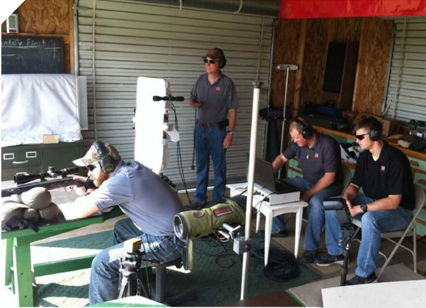
Hornady Ingenieure benutzen ein Doppler-Radar, um die Effekte der aerodynamischen Hitzeeinwirkung zu erforschen und um die Effizienz der Heat Shield-Spitze zu dokumentieren.
